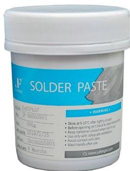
Свинцово-оловянная паста содержит 63% – олова, 37% – свинца. Температура преднагрева составляет от 90°C до 150°C, температура плавления - 183°C, диапазон температуры оплавления - от 183°C до +220°C.
