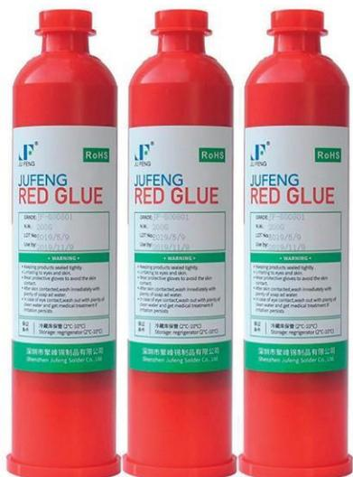
Клей для поверхностного монтажа состоит из эпоксидной смолы. В отличие от паяльной пасты, клей для поверхностного монтажа отверждается после предварительного нагрева: по достижению температуры затвердевания в 150°C клей мгновенно затвердевает. Представляет собой гель красного цвета, характеризуется высокой скоростью отверждения, отличной термостойкостью и электрическими свойствами, что обеспечивает качественную пайку. Идеально подходит для поверхностного монтажа при волновой пайке.
