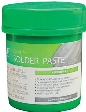
Тугоплавкая бесвинцовая паяльная паста содержит 99%–олова, 0,3%–серебра, 0,7%–меди. Температура плавления 217°C-227°C. Диапазон температуры предварительного нагрева составляет от 130°C до 210°C, температура оплавления - от 210°C до 245°C.
