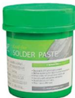
Тугоплавкая бессвинцовая паяльная паста содержит 99%-олова, 0,3%-серебра, 0,7%-меди. Температура плавления 217°C. Диапазон температуры предварительного нагрева составляет от 130°C до 210°C, температура оплавления – от 210°C до 245°C.
