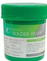
Бессвинцовая паяльная паста содержит 96,5% – олова, 3% – серебра и 0,5% – меди. Рабочие температуры можно разделить на три типа. Температуры предварительного нагрева находятся в пределах от 130°C до 170°C. Температура плавления составляет 217°C, а температура оплавления находится в диапазоне от 217°C до 245°C.
